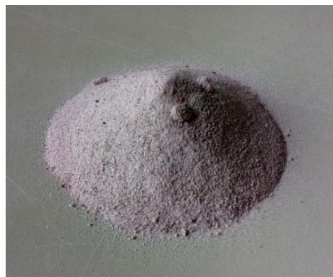
Arena residual de mina.
