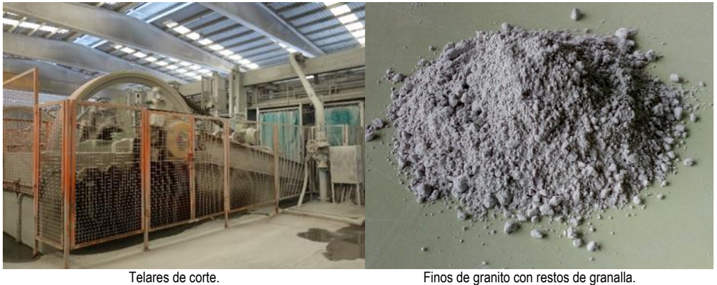
Figura 48. Proceso de obtención de los finos de granito con restos de granalla.
