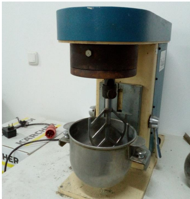
Figura 68. Amasadora de mortero para hormigones de prueba.
