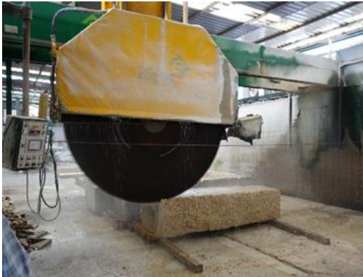
Proceso de corte de los bloques de granito.
