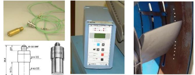
**Figura 3a.** Transductor de presión Kistler y amplificador (izqda). Agujeros en la carcasa para la medida de presión (dcha).
