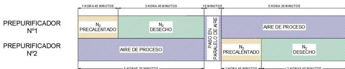
Ilustración 3.2. Esquema de funcionamiento secuencial de los pre-purificadores
