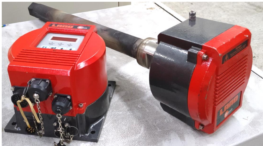
Figura 3.2. Imagen de la sonda de oxígeno Land con el equipamiento electrónico a la izquierda.
