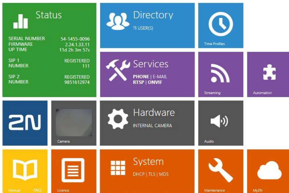
Figura 7. 6.- Pantalla principal del intercomunicador.
