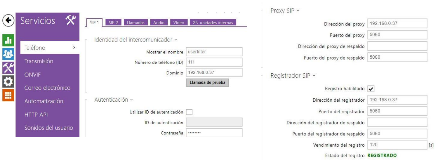
Figura 5. 3.- Pantalla de registro de usuario propio del Intercomunicador.
