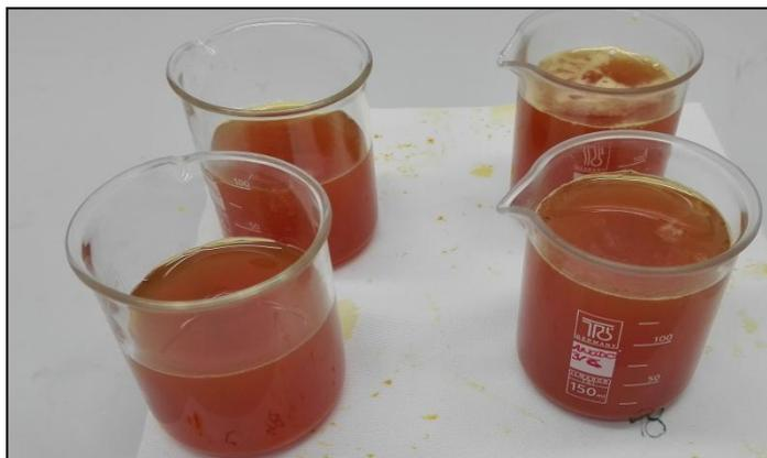
*Figura 5.2. Piezas sumergidas en cloruro férrico*
