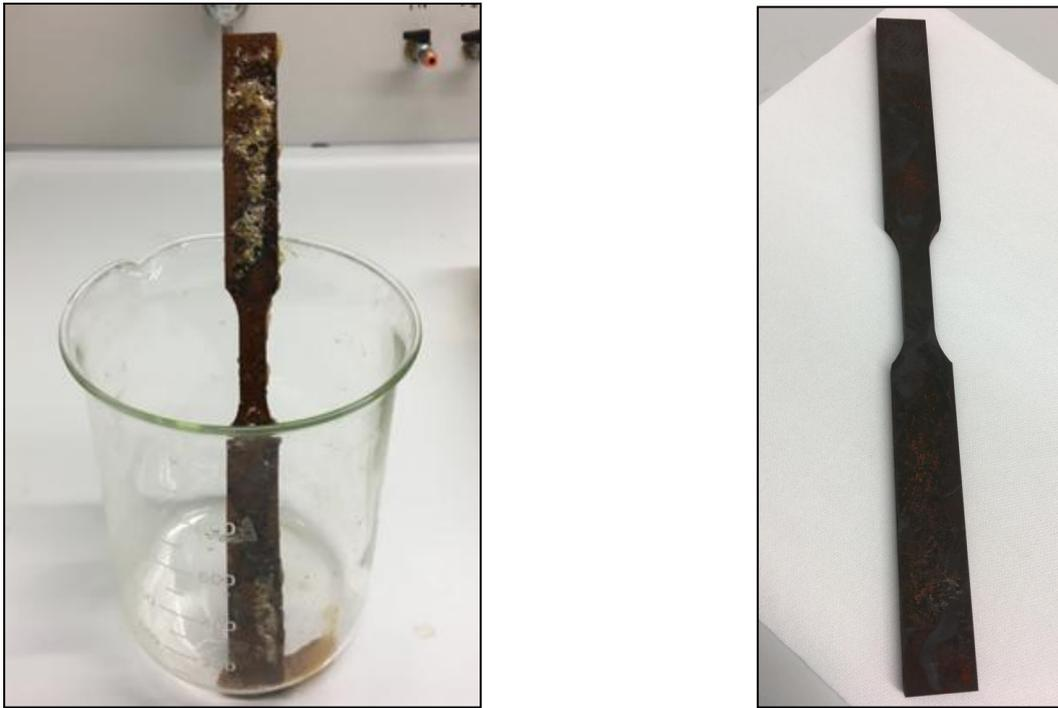
*Figura 5.6 Probeta tras 140 horas de corrosión. a) Probeta recién sacada de la solución b) Tras ser limpiada con agua*
