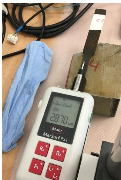
Figura 6.11. Medición de la rugosidad en la probeta C1 antes del ensayo de fatiga.
