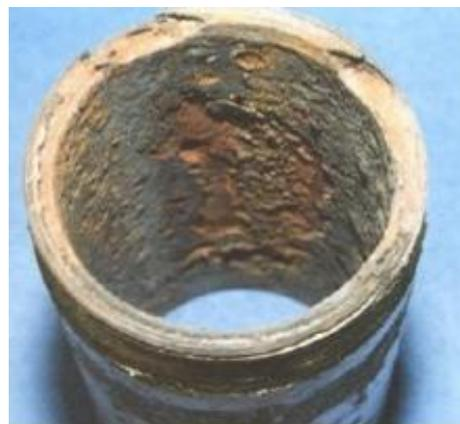
Figura 1.1. a) Corrosión externa por picaduras
