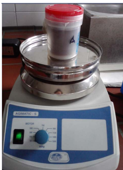
Figura 2. Muestras sometidas a agitación constante durante el proceso de envejecimiento.
