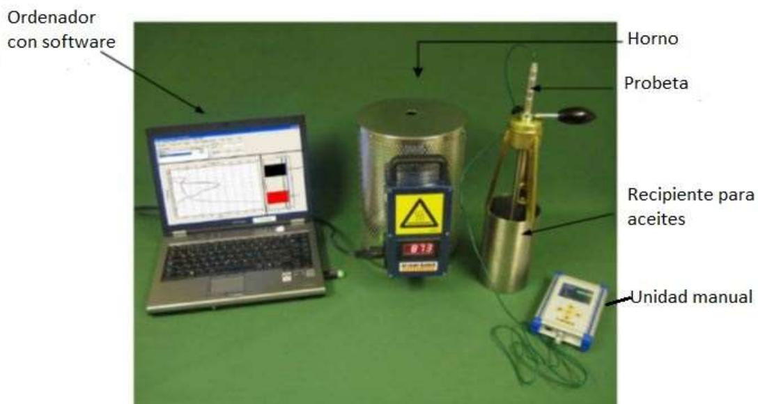
Figura 4.1. Vista general del sistema, Ivf SmartQuenc
