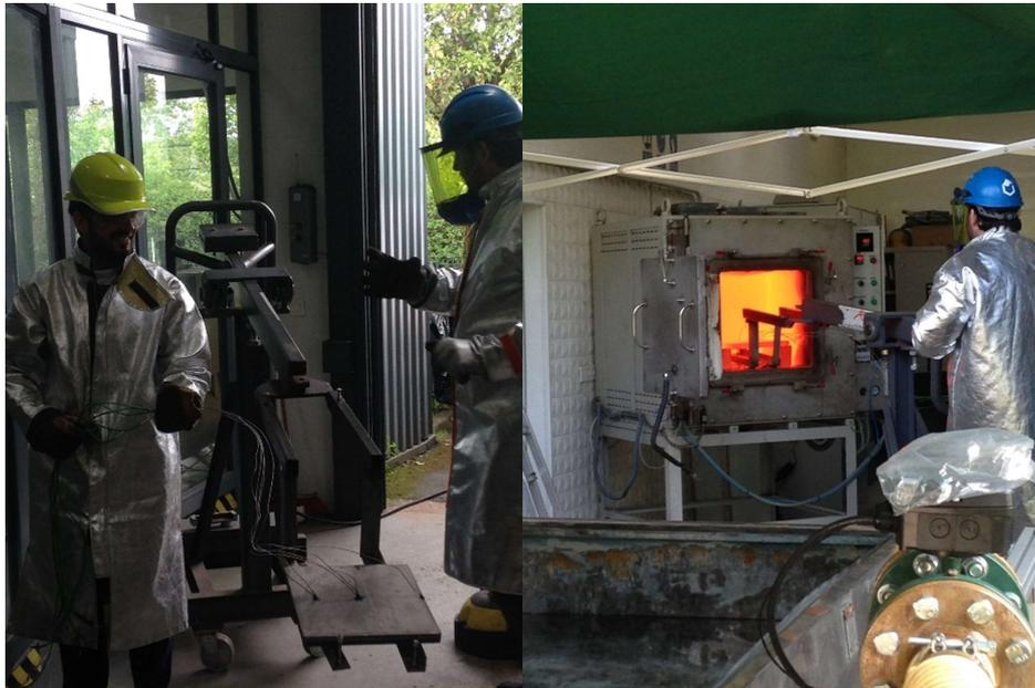
Figura 4.8. Procedimiento de trabajo para introducir la chapa en el horno
