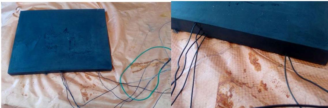
Figura 4.7. Colocación de los termopares en la chapa
