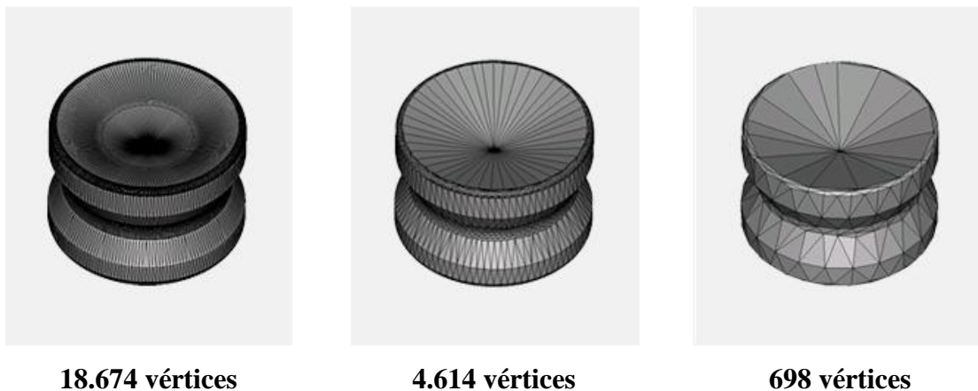
Figura 3.2.- Comparativa de la misma pieza en formato STL usando diferente número de vértices.
