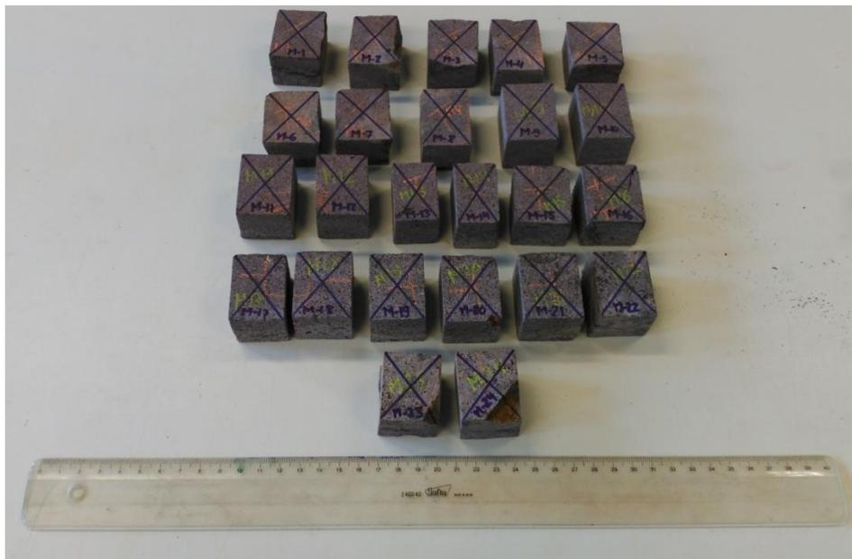
Figura 2.4.- Probetas tipo bloque para carga puntual. Escala: 40 cm.
