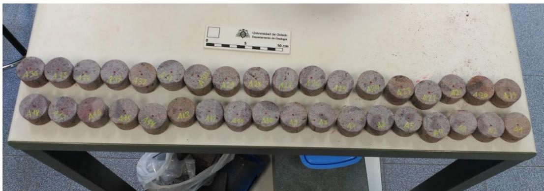
Figura 2.5.- Probetas pertenecientes al bloque 1 preparadas para el ensayo de carga puntual tipo testigo (ensayo axial).
