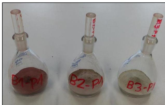
Figura 2.6.- Picnómetros con las muestras molidas para determinar la densidad real y la porosidad total.
