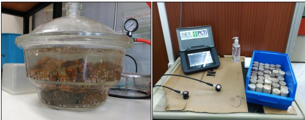
*Figura 2.7a (izquierda).- Muestras en agua destilada en condiciones de vacío.
