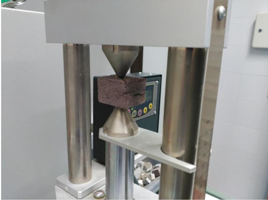
*Figura 2.8.- Máquina de carga puntual con una probeta tipo bloque.*
