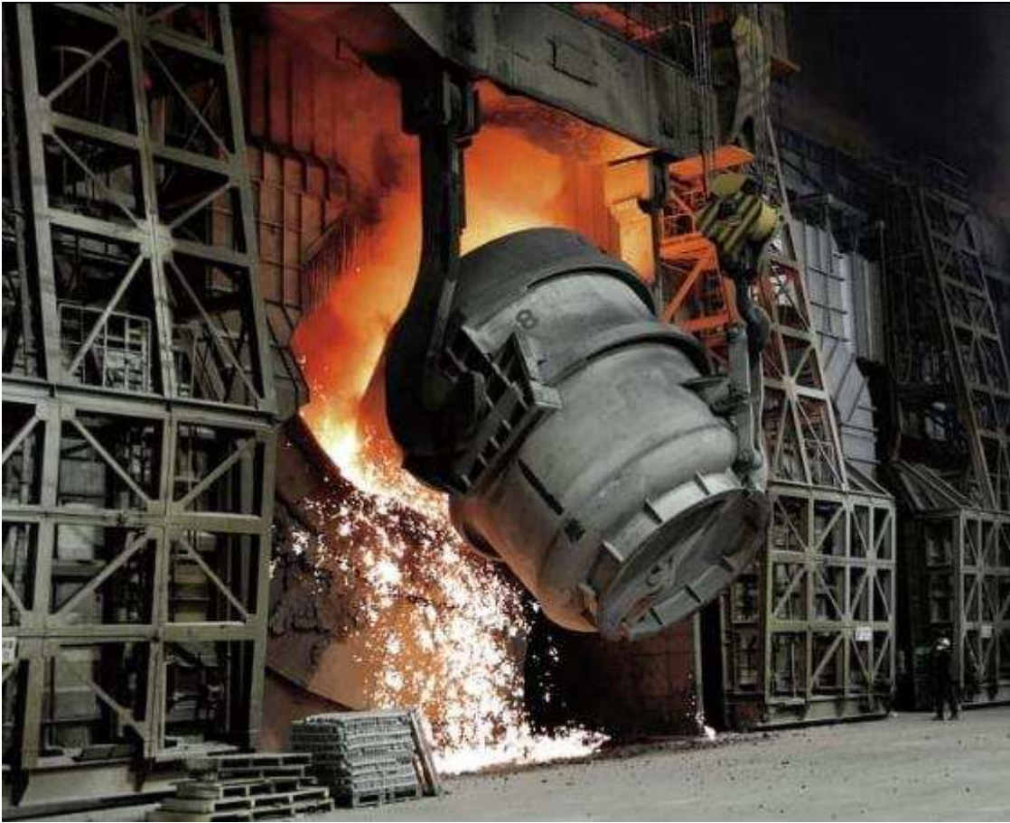
Figura 7: Convertidor volcando arrabio en una acería: Fuente: (DiarioMotor, 2013)
