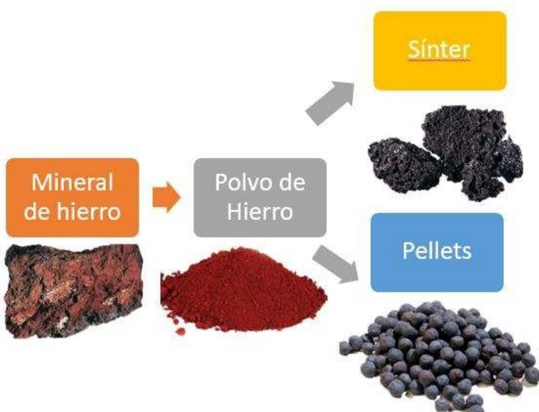
Figura 4: Esquema del mineral de hierro, de extracción a horno alto. (Fuente: Elaboración propia)
