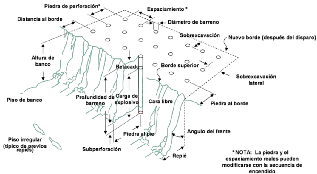
Figura 9 Parámetros geométricos para el diseño de la voladura (López Jimeno et al, 2003).
