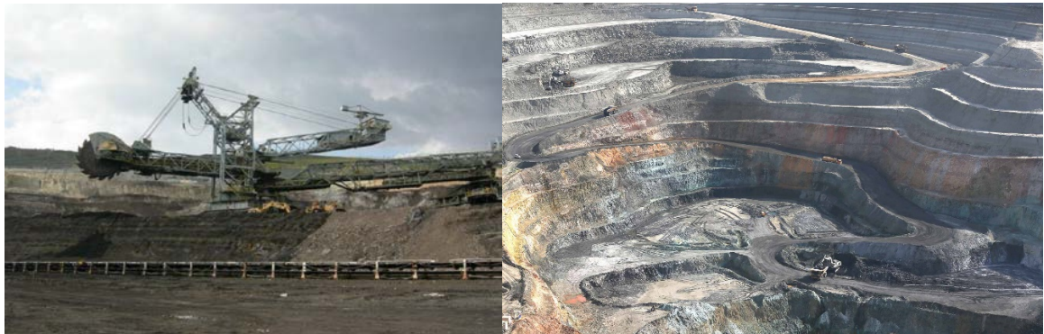
Ilustración 2. Izq. imagen de una rotopala. Der. imagen de un cielo abierto banqueado.
