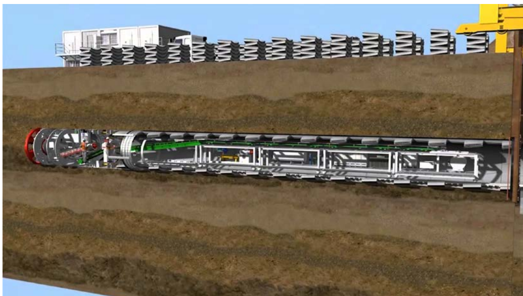
Ilustración 4. Esquema de una TBM. Se muestra la cabeza, el back-up y el almacén de dovelas en la superficie.
