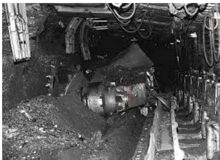
Ilustración 3. Imagen de una rozadora trabajando sobre una capa de carbón. Se aprecia la rozadora, el panzer, y la automarchante.
