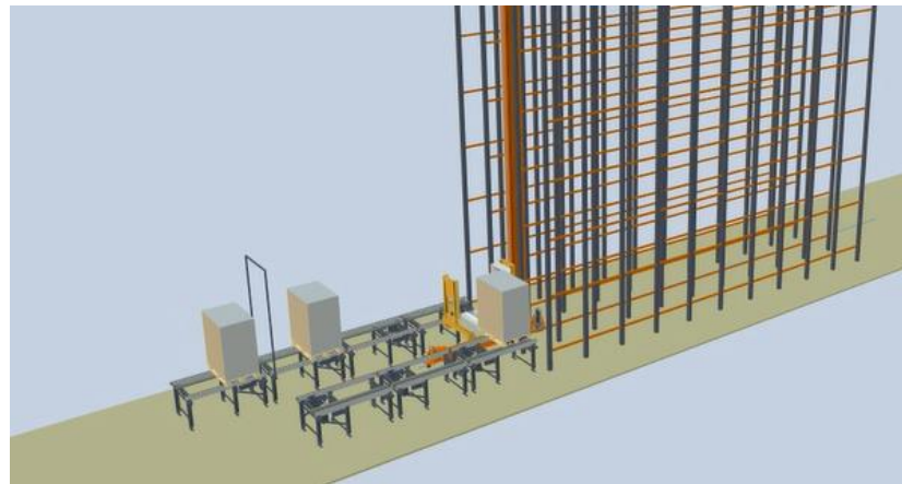
Figura 6.11.- Descarga de contenedor en MS
