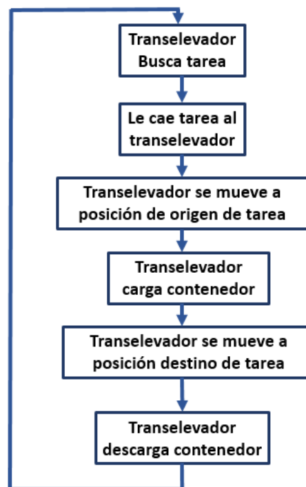
Figura 4.1.- Operativa de funcionamiento normal de un transelevador
