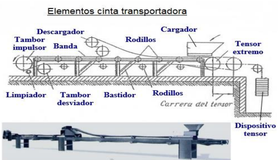
Figura 10. Elementos cinta transportadora.
