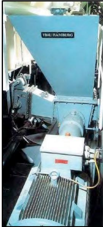
Figura 77. Bomba y compuertas M/V Goliath.
