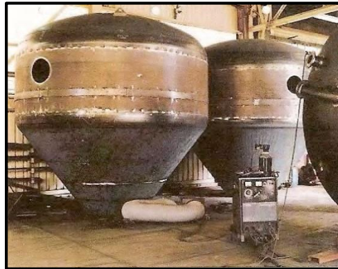
Figura 31. Tanques de descarga.
