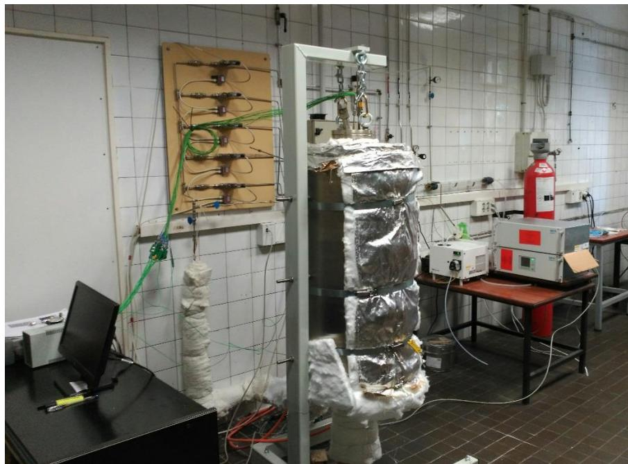
**Figura 5.1:** Fotografía del equipo experimental del INCAR. Incluye: sistema de alimentación y precalentamiento de gases, reactor tubular, horno, vaina de termopares, analizadores de gases y equipo de adquisición de datos.
