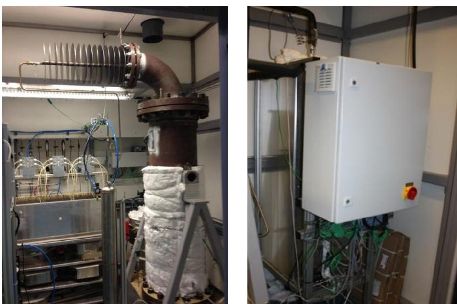
**Figura AI.2:** Dispositivos experimentales de la TUe. Izquierda: reactor de mayor tamaño a presión (DI x L, 0.063 x 1.58 m); derecha: reactor de menor tamaño a presión atmosférica (DI x L, 0.03 x 1.50 m).
