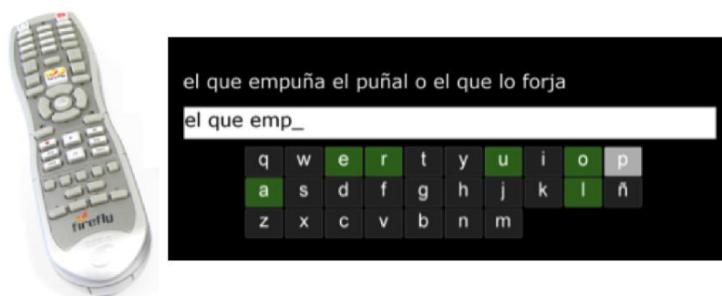
Fig. 2. Mando a distancia SnapStream FireFly y captura de la pantalla de la aplicación utilizada durante las pruebas.
