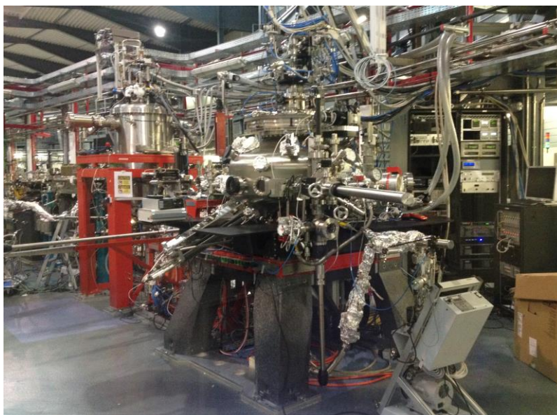
Figura 18. Imagen de la línea BOREAS del sincrotrón ALBA, mostrando, de izquierda a derecha, la estación HECTOR para medidas de dicroísmo magnético circular y lineal, y la estación MARES para medidas de dispersión resonante [20].
