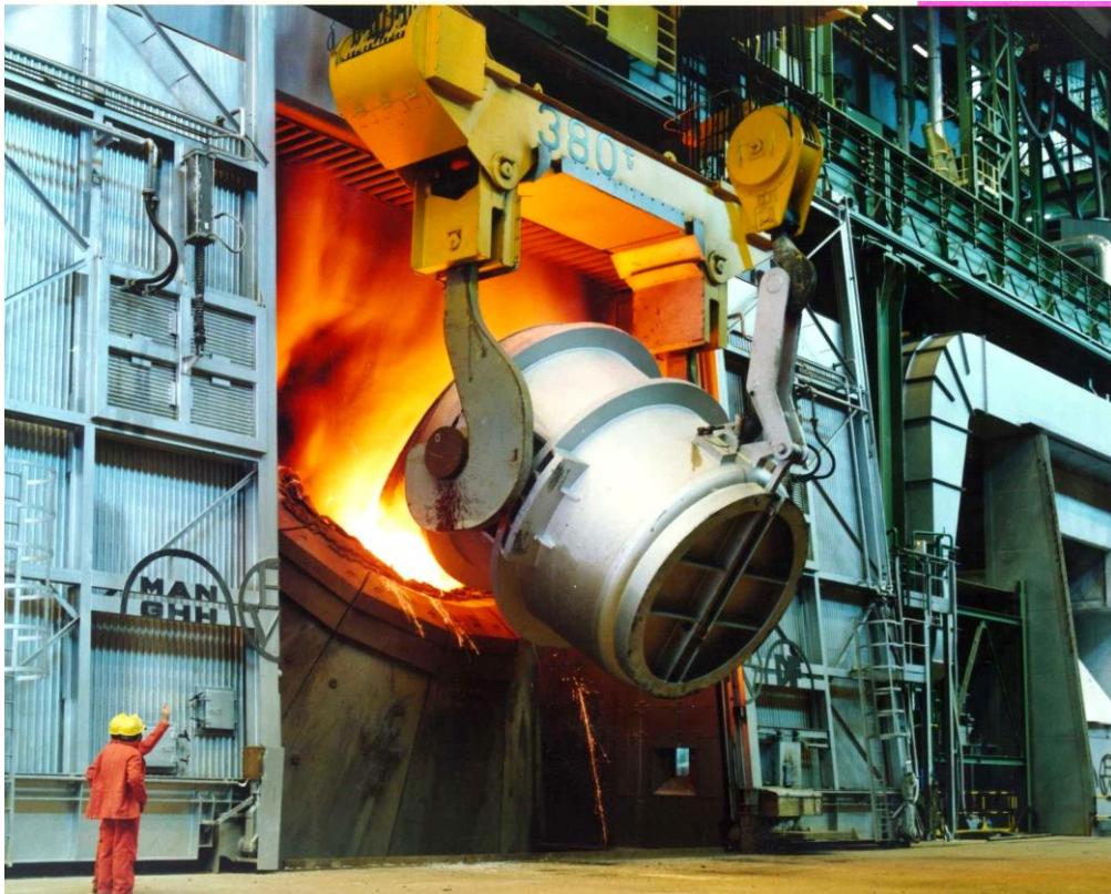
Fig.113. Imagen actual de un convertidor. La cuchara bascula su contenido de arrabio dentro convertidor. Inmediatamente después una lanza inyectará oxígeno a la carga con lo que se rebajará su contenido de carbono. Archivo histórico de la empresa Duro Felguera, S.A.
