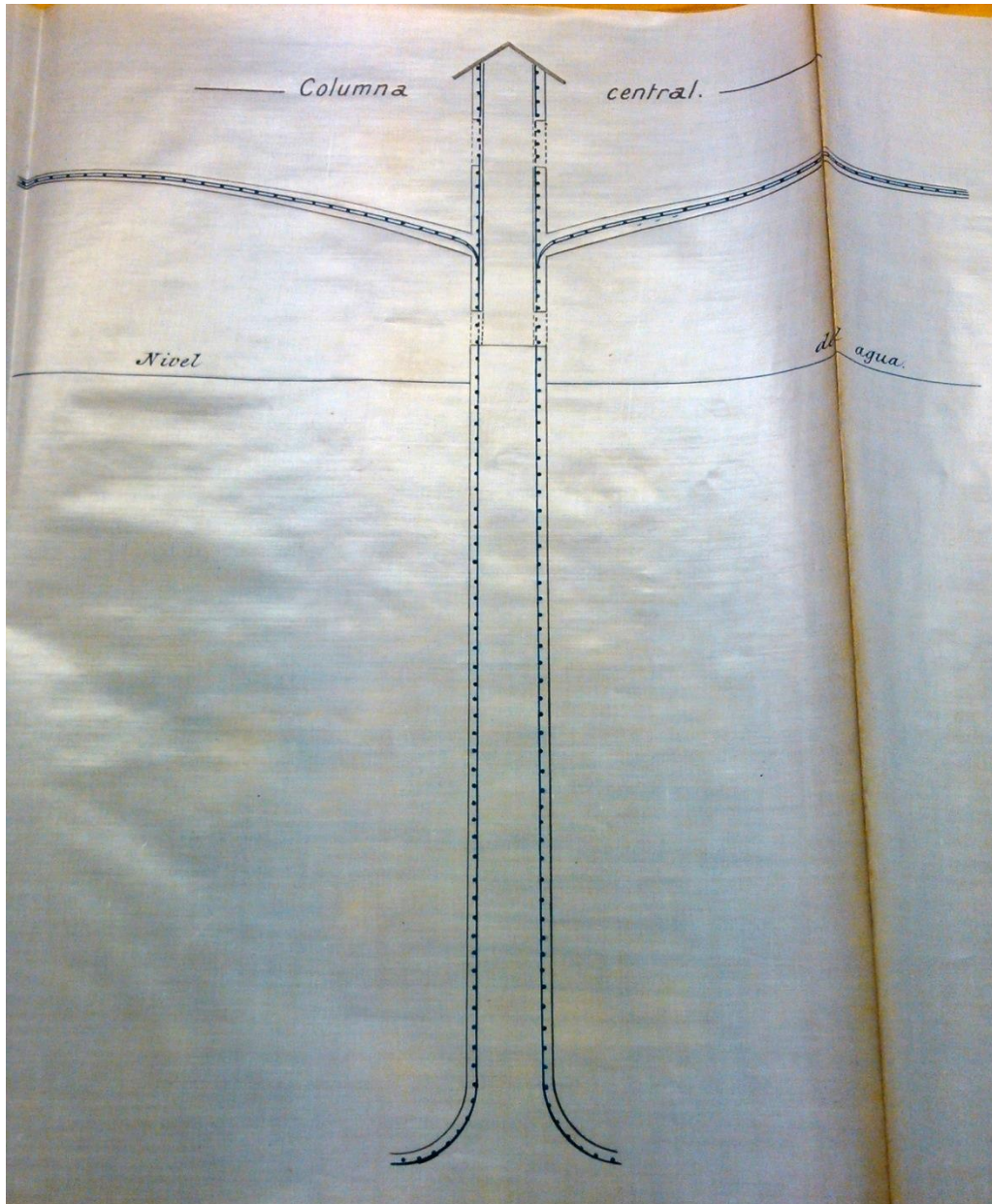
Fig.246. Detalles de la columna central de la cubierta de la solución depósito circular sistema Monier. 1900. Archivo Municipal de Gijón. Expediente No.132
