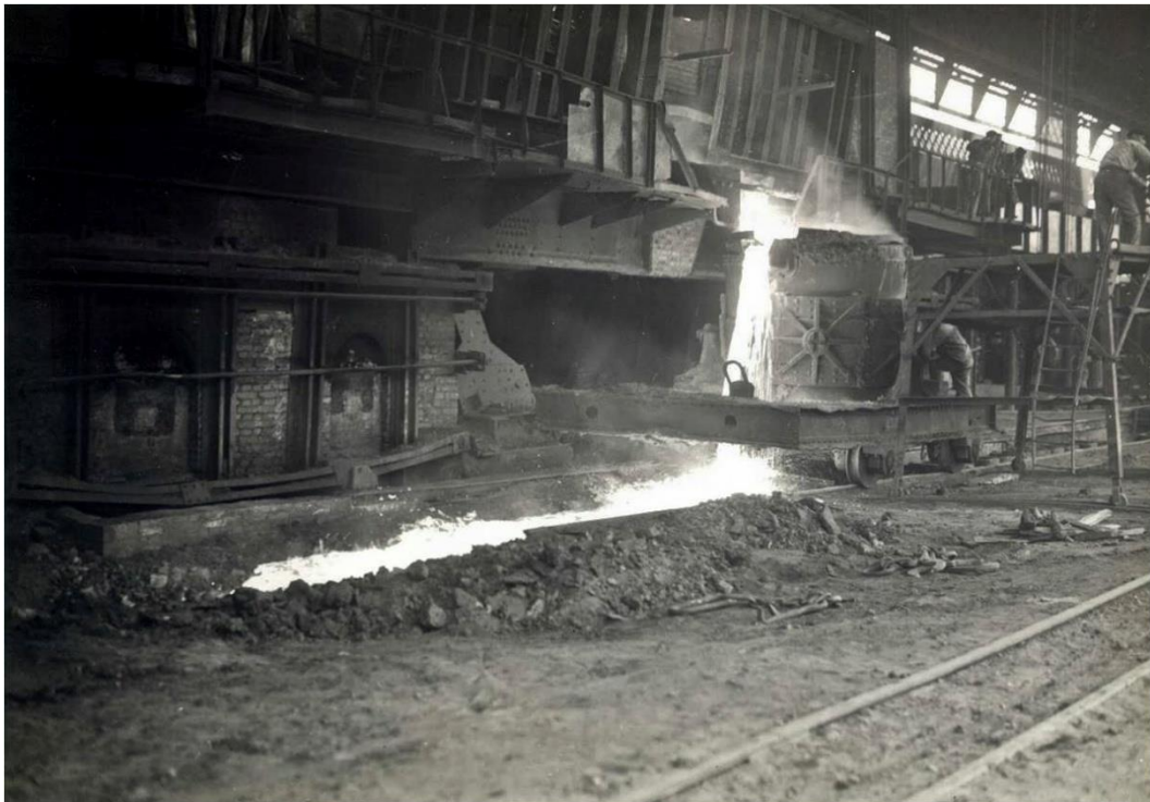
Fig.112. Acería de la antigua fábrica de Duro Felguera, en primer plano, a la izquierda, los primitivos hornos de reverbero. Archivo histórico de la empresa Duro Felguera, S.A.
