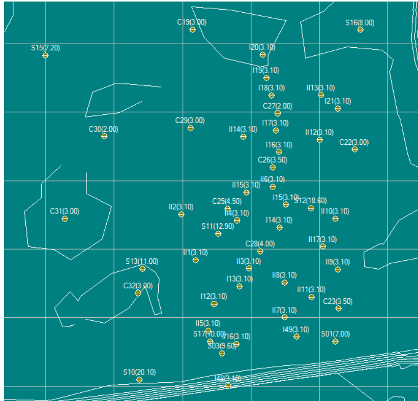
Ilustración 36: Ubicación de los sondeos/calicatas conocidos sobre la topografía de detalle en el software RecMin.
