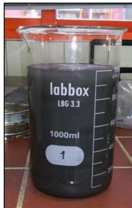
Figura 10. Suspensión inicial de partículas de pizarra en un vaso de precipitados.
