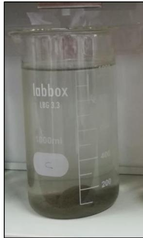
Figura 12. Agua clarificada obtenida en los ensayos de coagulación y floculación.
