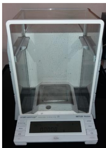
Fotografía 3.8. - Balanza analítica, marca Mettler Toledo , modelo AT261 DeltaRange .
