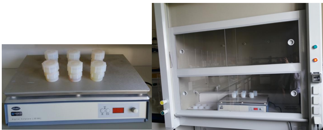
Fotografía 3.14 - A la izquierda: Placa calefactora marca Stuart modelo SD 500, a la derecha: Vitrina de gases marca Romero modelo FLOWtronic .
