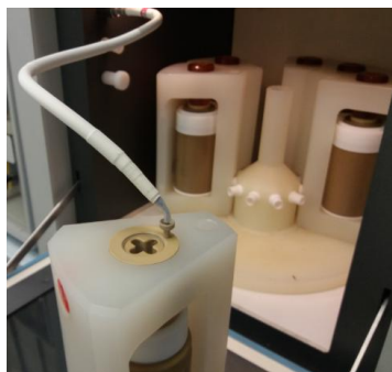
Fotografía 3.13 - Sonda de temperatura colocada en el vaso de control.
