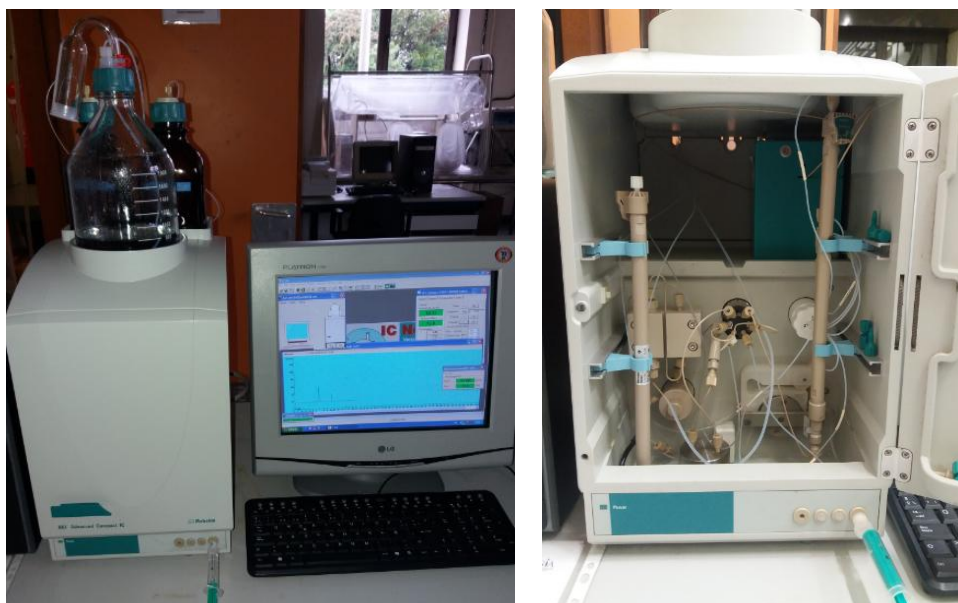
Fotografía 3.16 - Cromatógrafo líquido de alta eficacia, marca Metrohm , modelo 861 Advanced Compact IC .
