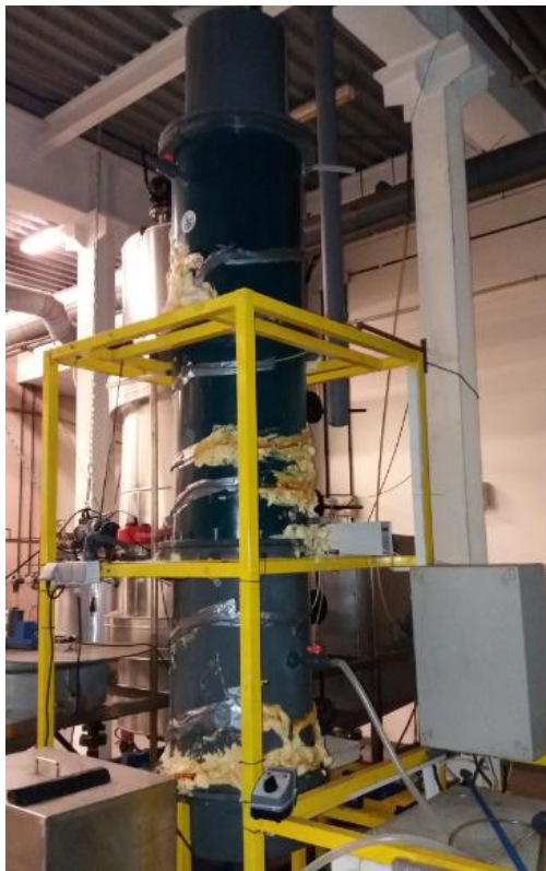
Fotografía 2.1 - Reactor de mezcla perfecta empleado en la digestión anaerobia de residuos de supermercado.
