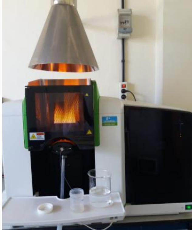
Fotografía 3.15 - Espectrómetro de absorción atómica, marca Perkin Elmer , modelo PinAAcle Serie 900F .
