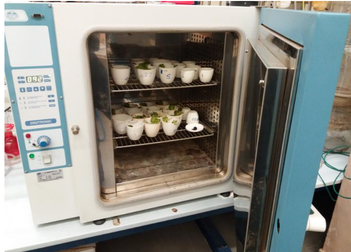
Fotografía 3.9 - Estufa de precisión universal "Digitronic", marca JP Selecta.
