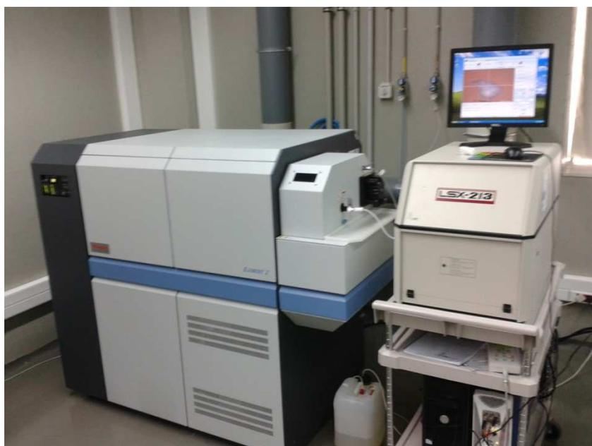
Figura 11 - Equipo de ablación láser acoplado al SF-ICP-MS.
