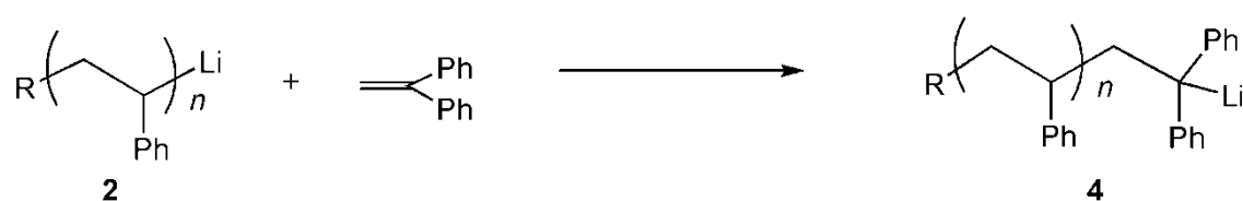
Esquema 7: Modulación de la reactividad del PS-Li ( 2 ) mediante la adición de 1,1-difeniletileno
