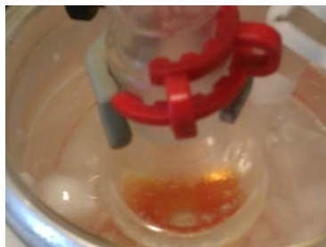
Figura 4: Disolución de PS-Li ( 2 ) en THF a -90\text{ }^{\circ}\text{C} .
