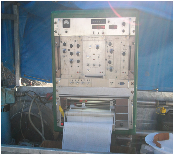
Figura 4. Equipo de registro de los datos y obtención de diagrfía.
