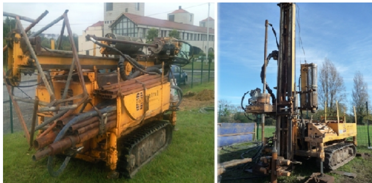
Figura 3. Máquina de perforación Realtec RL 46L del 2002.
