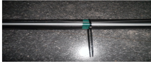
Figura 8. En el interior del tubo blanco se encuentran los sensores del tipo DS18S20.
