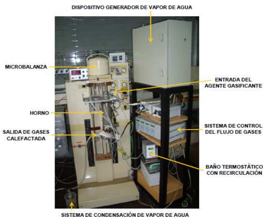
Figura 3.5 Fotografía de la termobalanza Setaram TAG24 modificada.
