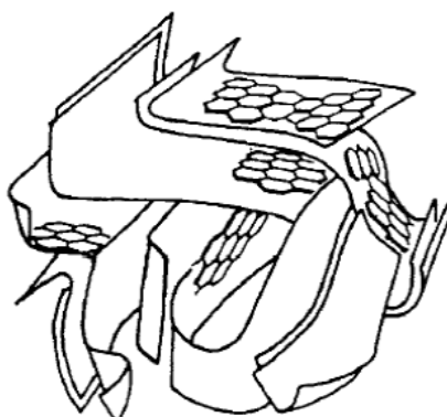
Figura 3.1 Estructura esquemática de un carbón activado propuesta por Oberlin y colaboradores [115].
