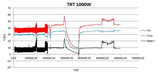
**Figura 7.** Evolución  $T_{(fl,in)}$ ,  $T_{(fl,out)}$  y  $\Delta T = T_{(fl,in)} - T_{(fl,out)}$  en los ensayos TRT.
