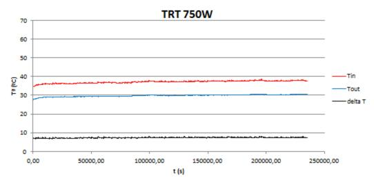
**Figura 6.** Evolución  $T_{(fl,in)}$ ,  $T_{(fl,out)}$  y  $\Delta T = T_{(fl,in)} - T_{(fl,out)}$  en los ensayos TRT.
