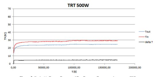
**Figura 5.** Evolución  $T_{(fl,in)}$ ,  $T_{(fl,out)}$  y  $\Delta T = T_{(fl,in)} - T_{(fl,out)}$  en los ensayos TRT.
