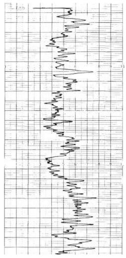
Figura 10. Diagrafía Gamma Natural obtenida con el equipo de testificación Mount Sopris 3000.
