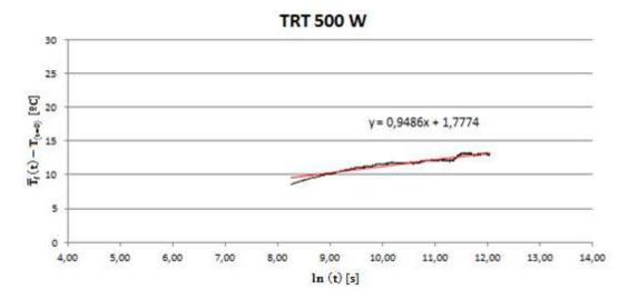
**Figura 11.**  $\bar{T}_f(t) - T_{(t=0)}$  vs. ln(t) en los ensayos TRT.
