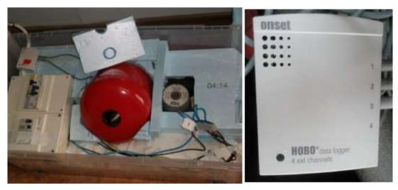
Figura 2. Equipo TRT y dispositivo Data logger HOBO U12-006 utilizados en el sondeo geotérmico.
