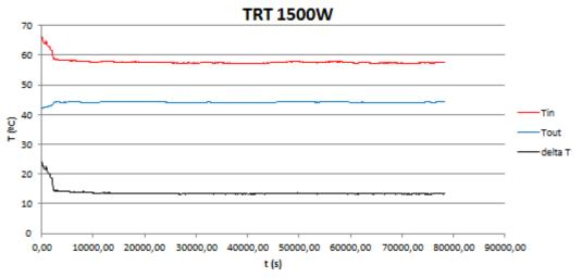
**Figura 8.** Evolución  $T_{(fl,in)}$ ,  $T_{(fl,out)}$  y  $\Delta T = T_{(fl,in)} - T_{(fl,out)}$  en los ensayos TRT.
