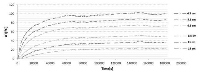
Figura 9. Evolución del incremento de temperatura en una muestra de caliza para cada uno de los sensores.
