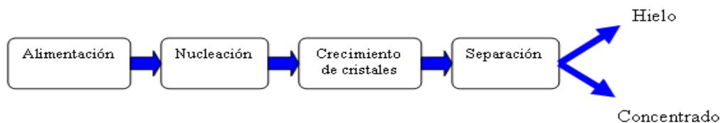
**Figura 13. – Esquema de las fases del proceso de concentración por congelación**
