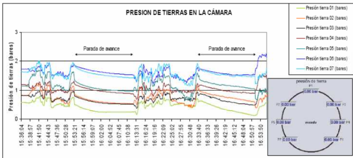
Figura nº4.: Control de presiones de una EPB
