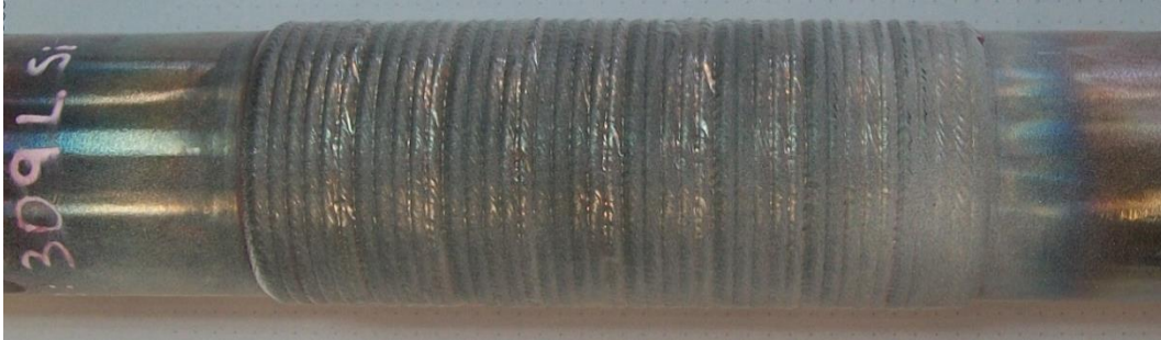
Figura 53: Ausencia de indicaciones en el ensayo de líquidos penetrantes sobre el cupón 4
