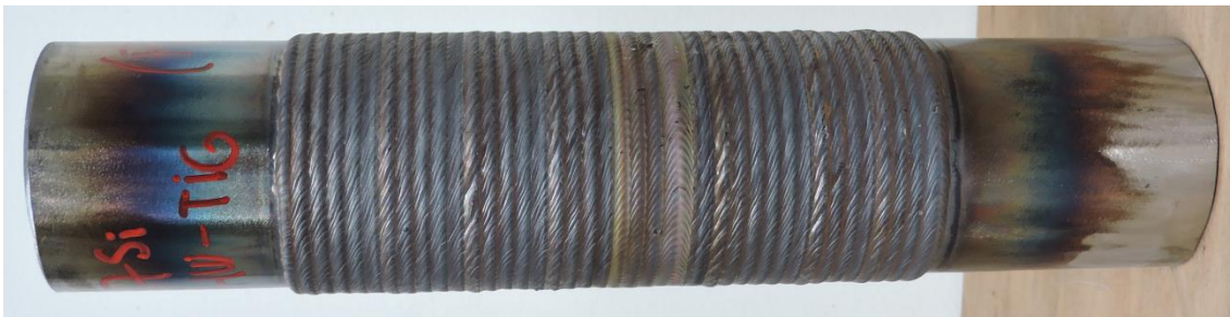
Figura 46: Tubo de P22 recargado con ER347Si mediante Hot Wire TIG
