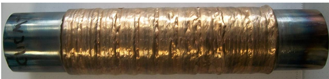
Figura 40: Aspecto final del tubo de acero 16Mo3 recargado mediante CMT con hilo CuSi3Mn1 en posición PA.
