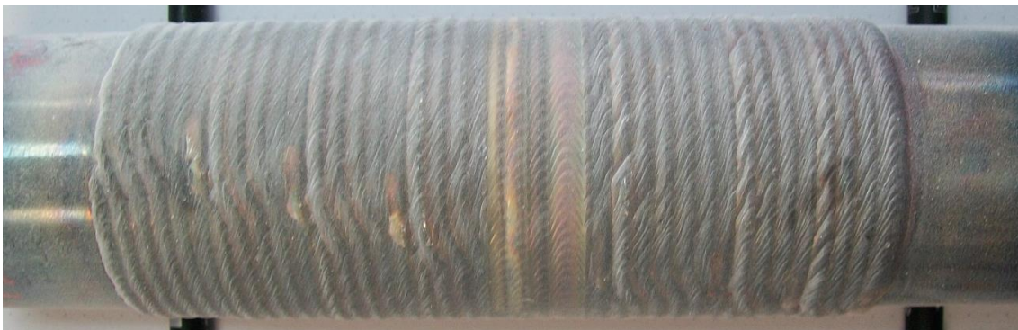
Figura 56: Resultado del ensayo por líquidos penetrantes en el cupón 5
