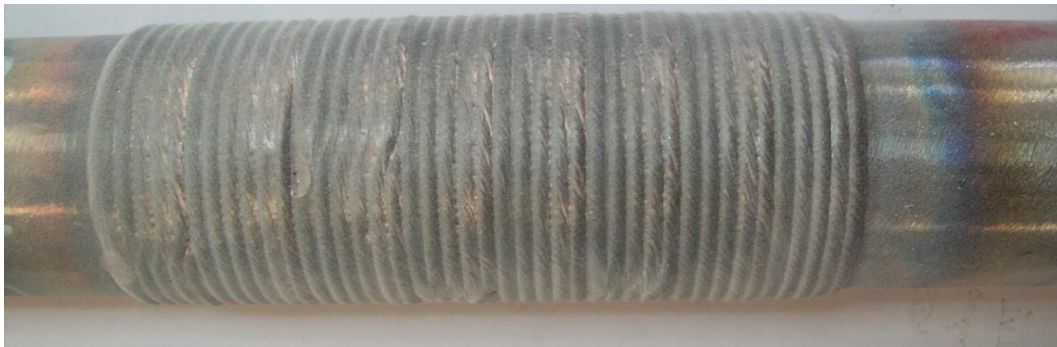
Figura 51: Ausencia de indicaciones en el ensayo de líquidos penetrantes del cupón 3
