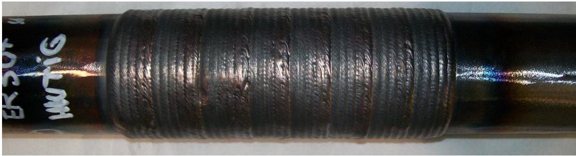
Figura 43: Aspecto del tubo de P22 recargado con ER307 mediante Hot Wire TIG
