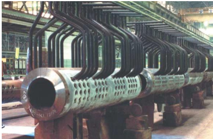
Figura 1: Vista de un "header" típico de una planta energética. (1)
