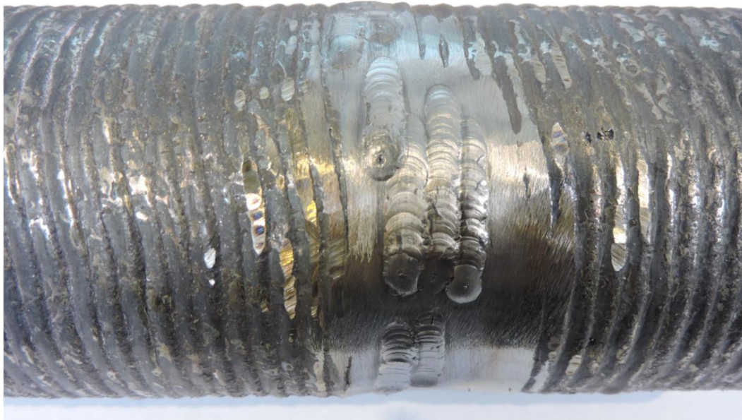
Figura 50: Aspecto del cupón 2 tras ser reparado mediante TIG manual
