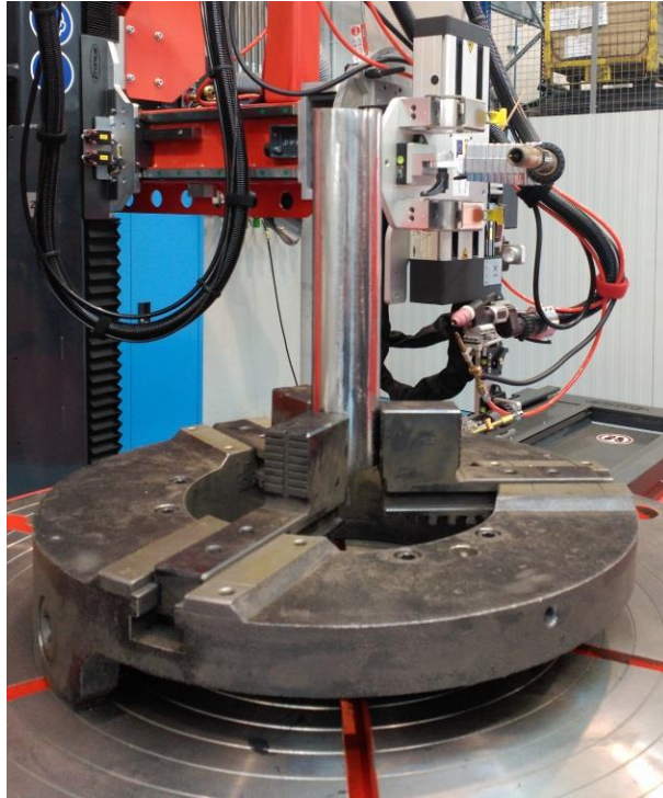
Figura 34: Tubo preparado y anclado listo para ser soldado en PC
