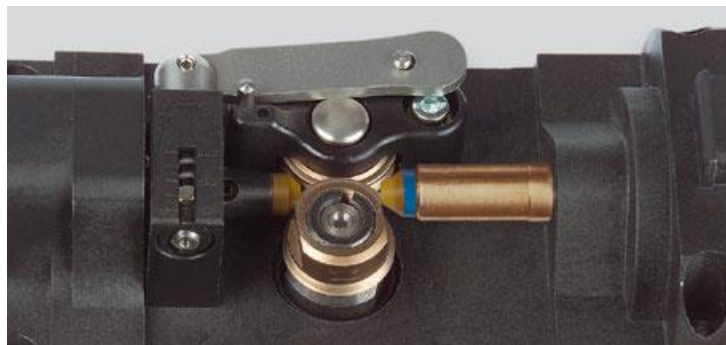
Figura 29: Sistema de arrastre del hilo de la antorcha
