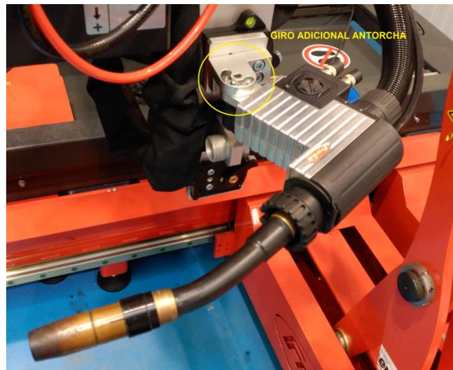
Figura 38: Sistema que permite el giro adicional de la antorcha CMT para modificar su ángulo de avance
