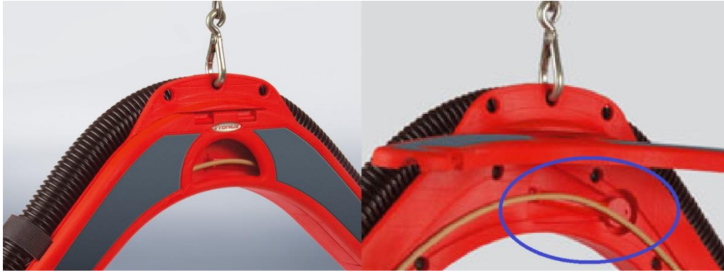
Figura 28: Buffer de hilo CMT. Detalle muelle para acumulación de hilo.
