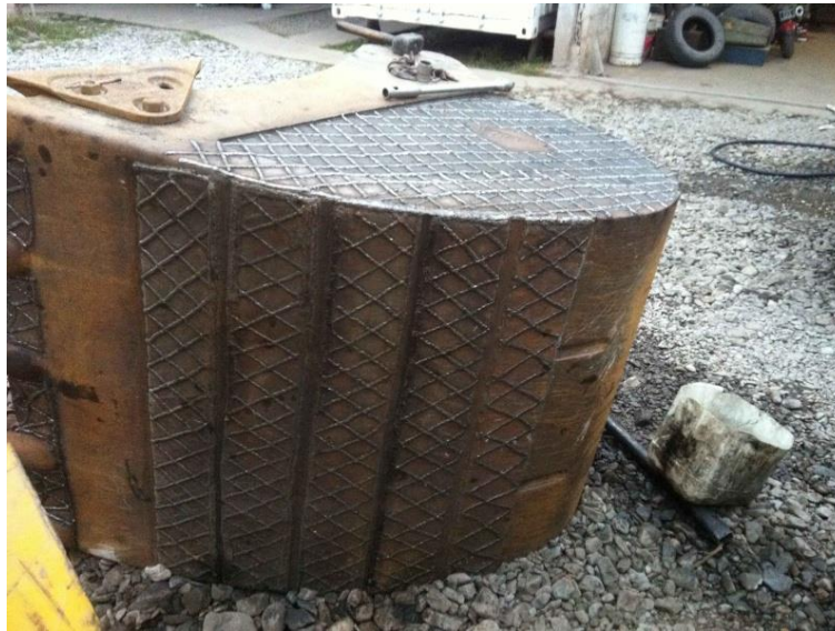
Figura 2: Recargue duro en la cuchara de una excavadora
