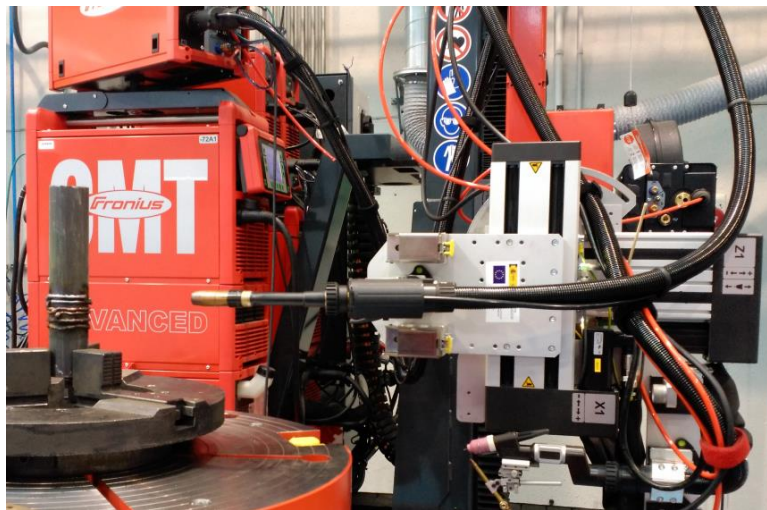
Figura 36: Antorcha CMT colocada en el conector principal. Ejes X1 y Z1 girados 90° con respecto a su posición original
