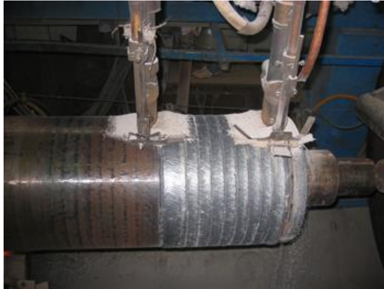
Figura 3: Recargue mediante arco sumergido de un rodillo
