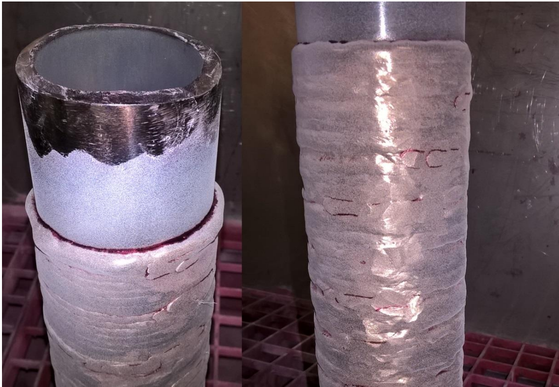
Figura 48: Indicaciones de defectos reveladas mediante el ensayo de líquidos penetrantes en el cupón 1
