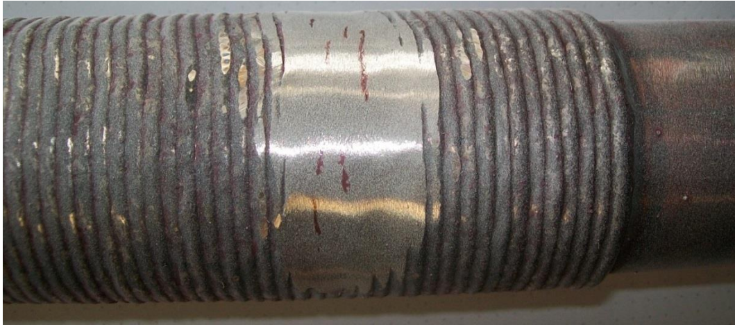
Figura 49: Indicaciones lineales en el ensayo de líquidos penetrantes del cupón 2.
