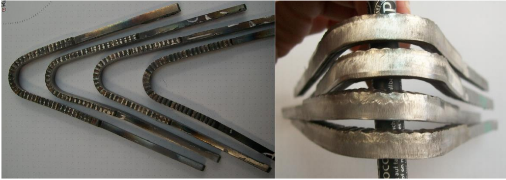
Figura 55: Probetas del Cupón 4 tras ser sometidas al ensayo de doblado
