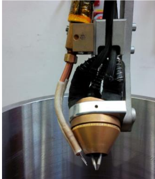
Figura 6: Antorcha de doble cátodo empleada en este trabajo (FRONIUS SpeedClad®)
