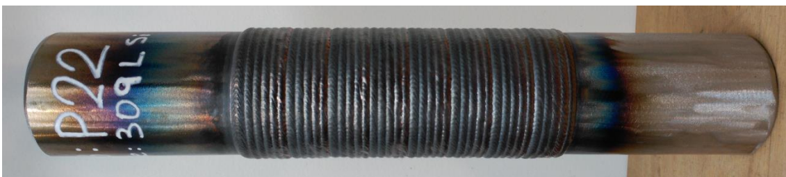
Figura 44: Tubo de P22 recargado con hilo 309LSi mediante Hot Wire TIG
