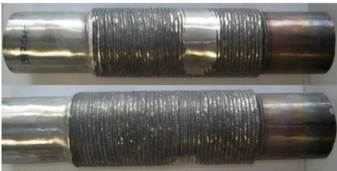
Figura 42: Aspecto del tubo de acero P22 recargado con ER347Si mediante CMT. Reparado con CMT. Amolado en la zona reparada.
