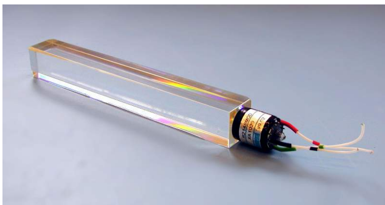
Figura 2.9: Uno de los 15000 cristales de wolfrato de plomo del endcap del ECAL del CMS junto al fotomultiplicador pegado a él. [17]
