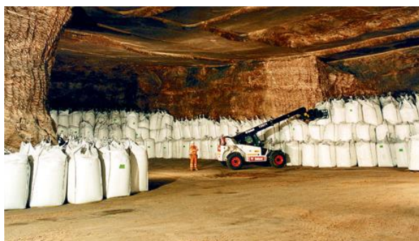
Ilustración 13. Almacenamiento de residuos peligrosos en la mina de Cheshire (Reino Unido) (Fuente: Veolia, 2006)
