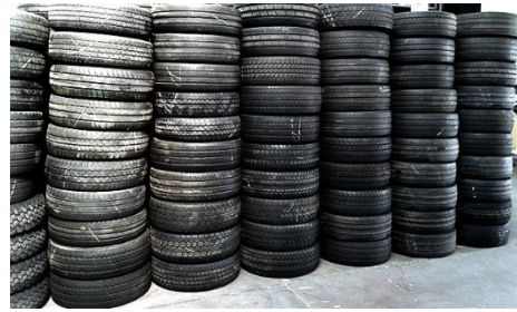
Ilustración 29. Disposición de apilamiento de neumáticos
