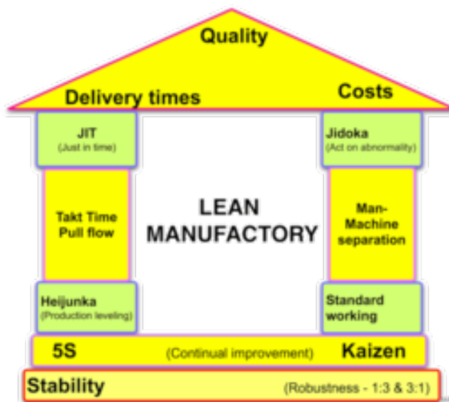
Ilustración 3.8: Ilustración de la metodología Lean, con Kaizen en uno de sus pilares
