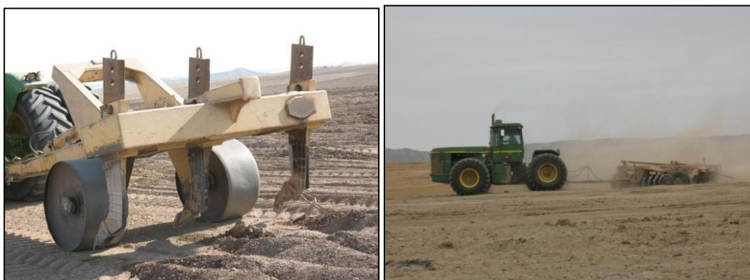
**Figura 5.22** Labores de subsolado y rastrillado.
