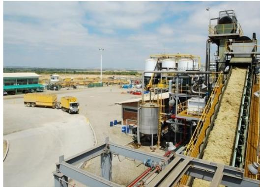
**Figura 5.27** Recepción, descarga y alimentación de la caña de azúcar
