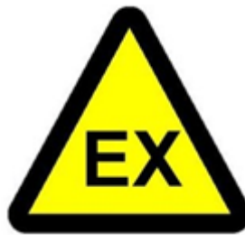
Figura 6. Señal de riesgo de atmósferas explosivas
