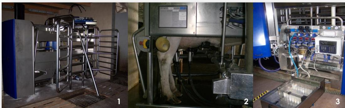
Figura 3.3.3.1.1. Sistema automatizado de ordeño del rebaño experimental de leche del Área de Nutrición, Pastos y Forrajes de SERIDA. 1: Robot de ordeño; 2: Vaca en ordeño; 3: Muestreador automático.
