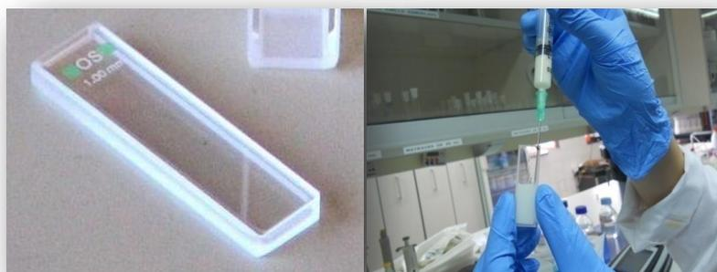
Figura 3.4.3.2.1. Cubeta de cuarzo para líquidos con paso óptico de 1mm para acople a microPHAZIR™
