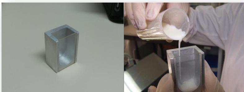
Figura 3.4.3.2.3. Cubeta de cuarzo para líquidos con paso óptico de 17 mm FOSS
