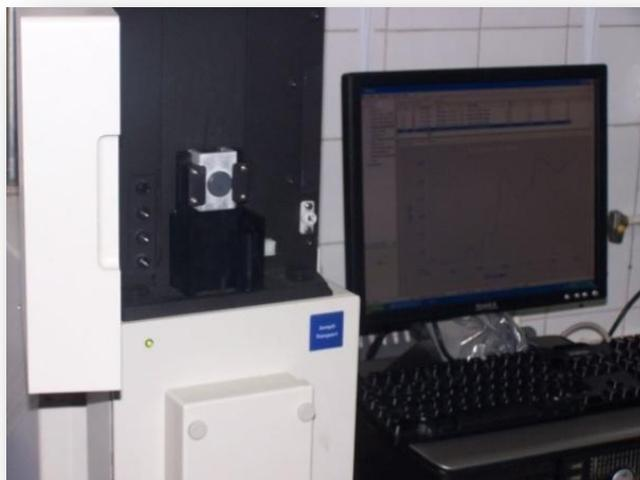
Figura 3.4.3.2.4. Equipos on-line FOSS NIRSystemss 6500 y cápsula para líquidos opacos
