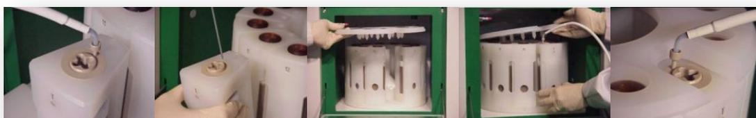
Figura 3.2.4.1. Detalle del termopar y sensor de T en el interior del horno MW
