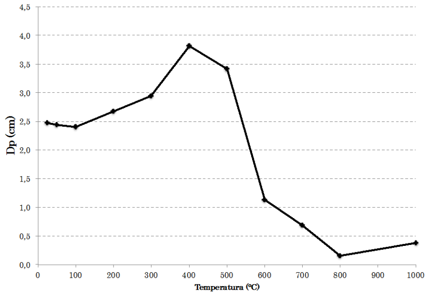
Figura 5.7 Distancia de penetración de las microondas en la mezcla captador + residuo (0.3:1) en función de la temperatura a 2.45 GHz
