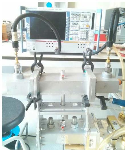
Figura 3.4 Guía de ondas NANOHOLDER (al frente) que contiene el tubo de cuarzo donde se inserta la muestra y analizador vectorial de redes (al fondo)
