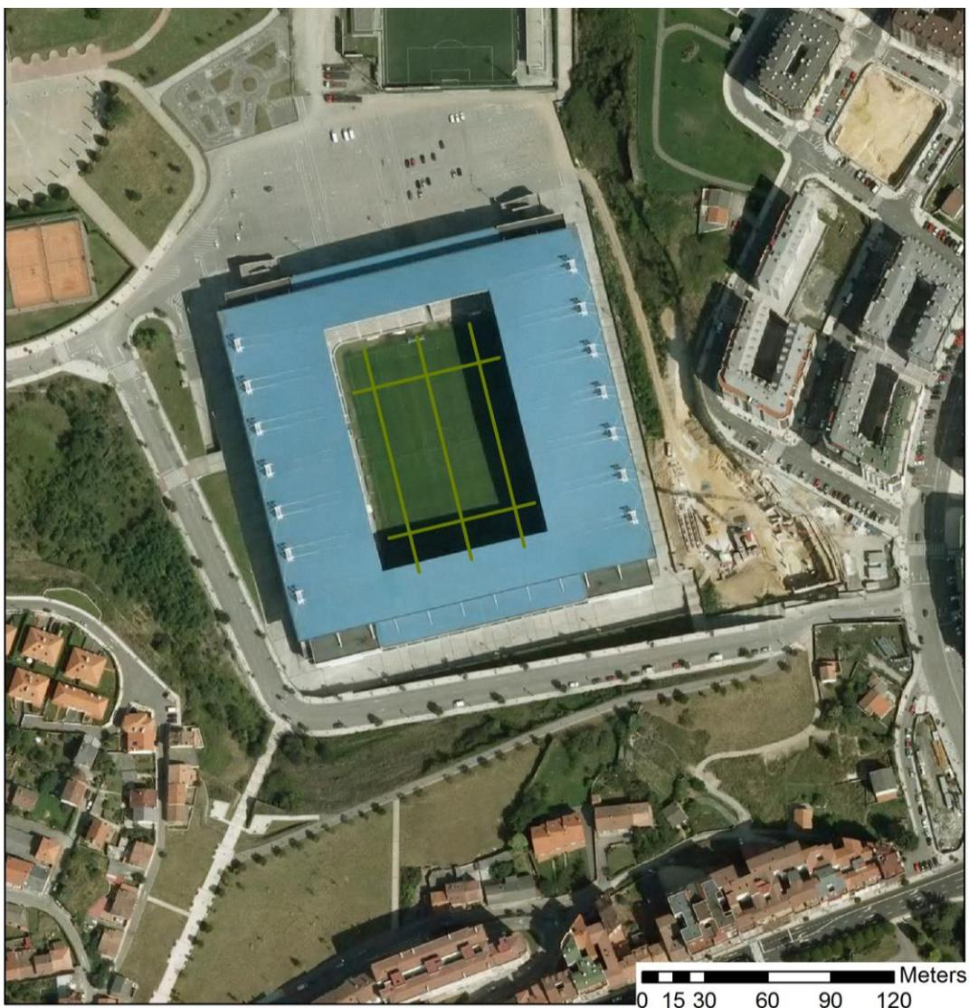
Figura 3.9a: Disposición de los perfiles de resistividad eléctrica realizados en la campaña de tomografía eléctrica sobre el césped del Nuevo Estadio Carlos Tartiere.
