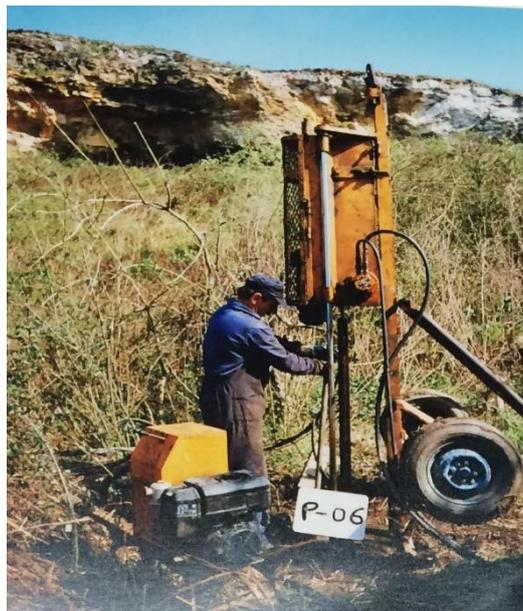
Figura 4.3: Penetrómetro Automático tipo MAGERIT realizando un ensayo de penetración dinámica continua en el entorno del nuevo Estadio Carlos Tartiere (AMO, 1998)
