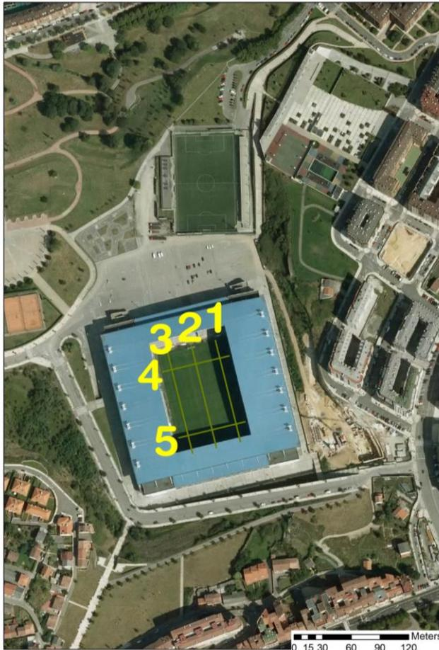
Figura 4.37: Emplazamiento de las secciones de resistividad de tomografía eléctrica sobre el césped del nuevo Estadio Carlos Tartiere.
