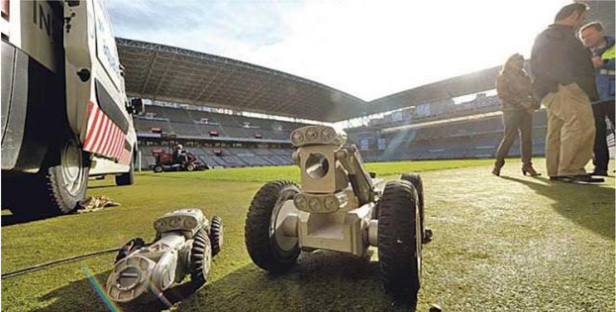
*Figura 4.8: Robot de propiedad municipal empleado para revisar el estado de los canales longitudinales de drenaje del Estadio Municipal Carlos Tartiere (LNE, 2012).*
