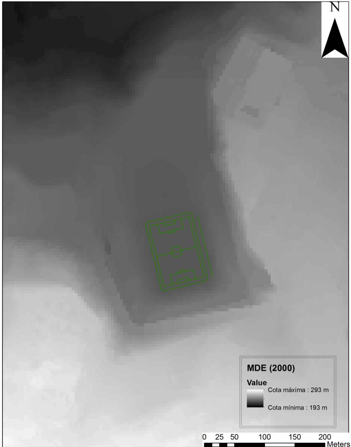
Figura 4.33: Modelo Digital de Elevación generado en un sistema de información geográfica (GIS) a partir de los datos obtenidos mediante la técnica de LiDAR para el año 2000, tras la construcción del nuevo Estadio Carlos Tartiere y la urbanización de su entorno. Respecto a las anteriores imágenes obtenidas se observa que, para la misma área de estudio, la cota máxima ha aumentado y la mínima ha descendido.
