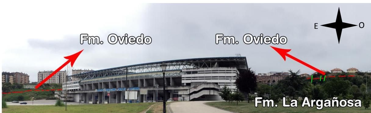
Figura 4.15: Panorámica E-O realizando una mirada desde la zona norte del área de estudio hacia el sur que muestra los contactos entre las Fm. Oviedo y Fm. La Argañosa en los taludes E y O del nuevo Estadio Carlos Tartiere de Oviedo/Uviéu.
