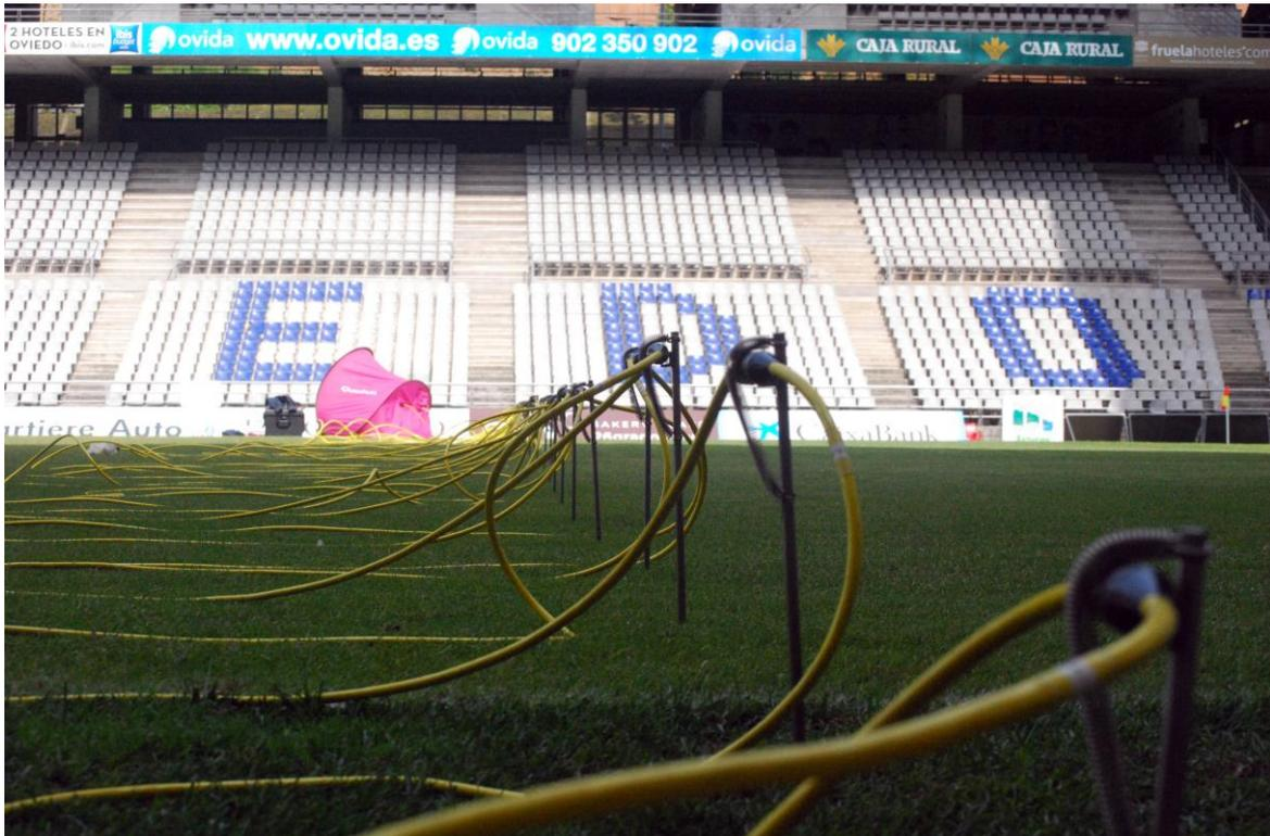
Figura 3.8: Disposición de los electrodos a lo largo del césped del Nuevo Estadio Carlos Tartiere, con el equipo de adquisición al fondo.
