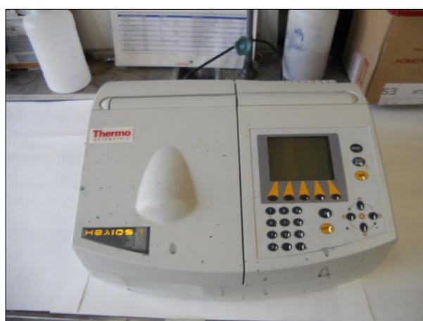
Figura 17. Equipo de espectrofotometría ThermoScientific Helios \gamma empleado en la experimentación
