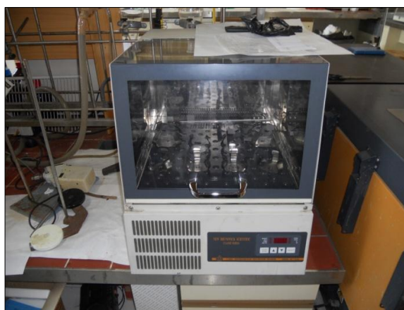
Figura 16. Incubadora "New Brunswick C24KC Refrigerated Incubator Shaker" empleada durante el proceso de hidrólisis enzimática
