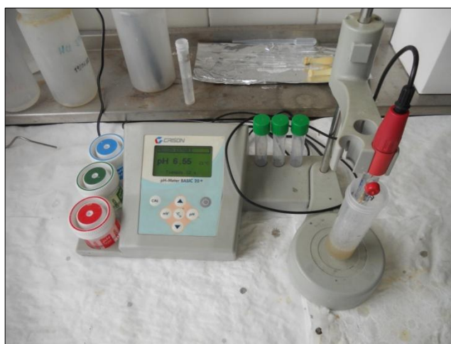
Figura 14. pH-metro (Crison Basic 20+) empleado en la experimentación
