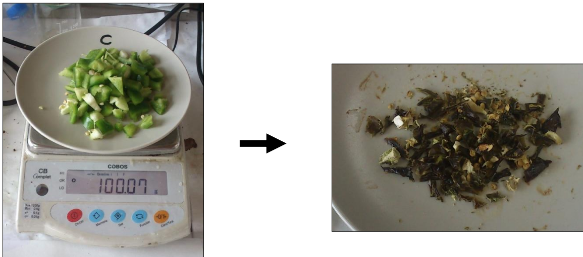
Figura 12. Resultado de la fase de deshidratación a 55°C durante 24 horas en las muestras de pimiento verde. En la figura de la izquierda se muestra el pimiento verde troceado y pesado en una balanza analítica (CB Complect COBOS), en la figura de la derecha el resultado después de secar la muestra.
