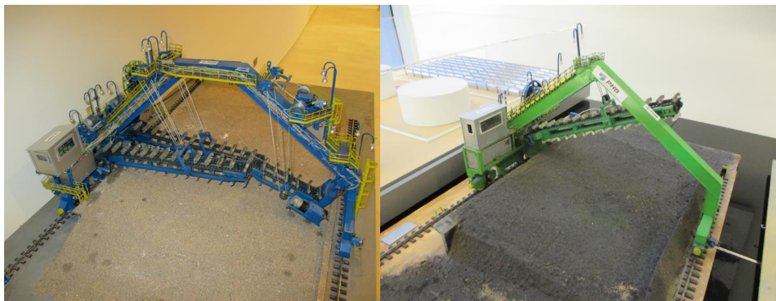
Figura 1: Reclaimer VP3 (tres brazos rascadores ) y Reclaimer VP1 (un brazo rascador) Existen otros equipos formados por dos brazos rascadores
