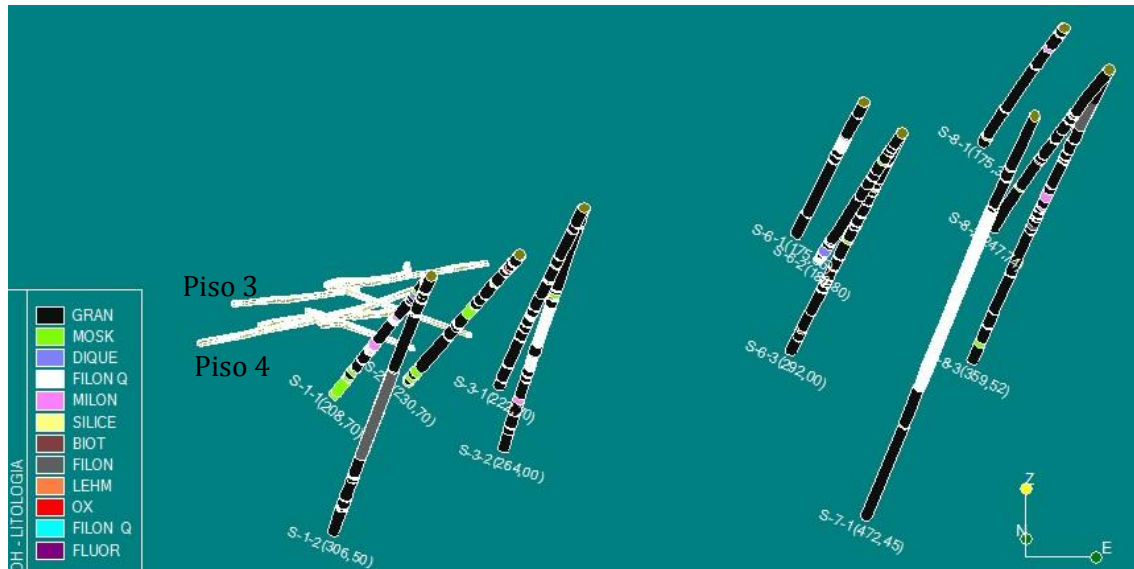
Figura 34. Modelización 3D de los pisos 3 y 4 de las minas de Penouta
