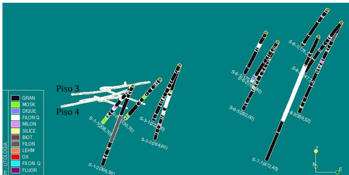
Figura 7. Modelización en RECMIN de los pisos hallados en los planos de la mina.
