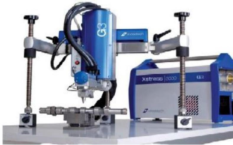
**Figura 12. Fotografía del equipo de Difracción de Rayos X.**
