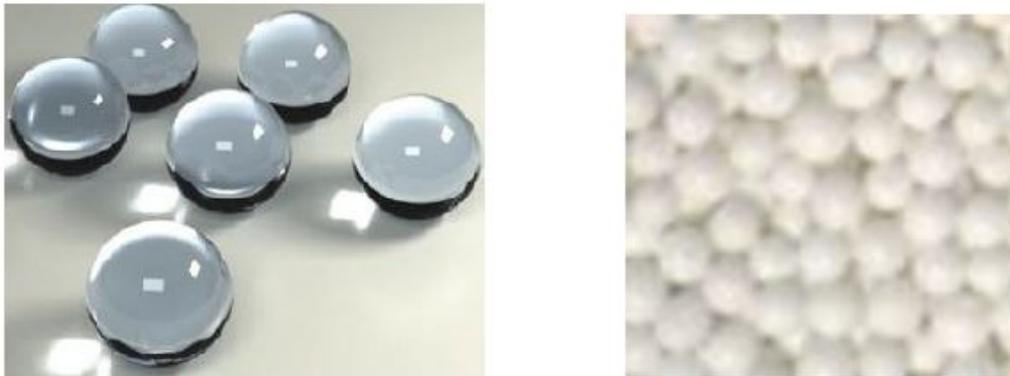
**Figura 7. Izda.: Microesferas de vidrio. Dcha.: Microesferas cerámicas.**
