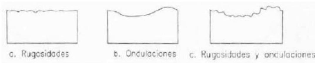
**Figura 15. Diferenciación entre ondulación y rugosidad.**
