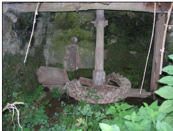
Fig. 210. Rodezno del molino del Real, con la rueda dentada y el árbol o eje. Bajo la rueda puede apreciarse el listón de madera correspondiente al puente y a la derecha, la tabla del “aliviu”, el mecanismo que permitía graduar desde el piso de arriba la altura del puente y con ello, la distancia entre las muelas.
