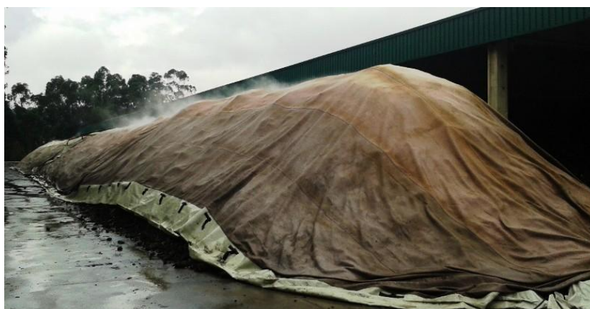
Figura 4. Pila de compost EDAR cubierta por una lona semipermeable que evita la lluvia, salida de gases y emisión de olores.
