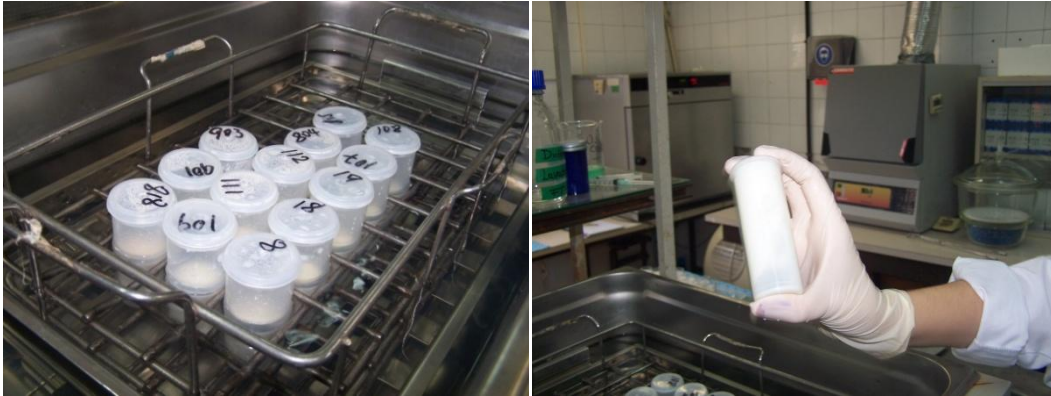
Figura 3.6. Muestras de leche en baño de agua a 40\pm 2^{\circ}\text{C} con agitación suave (izquierda) y agitación manual durante 20-30 segundos (derecha).
