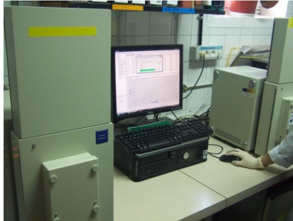
Figura 3.10. FOSS-NIRSystem 6500 trabajando a tiempo real a través del software ISIScan.
