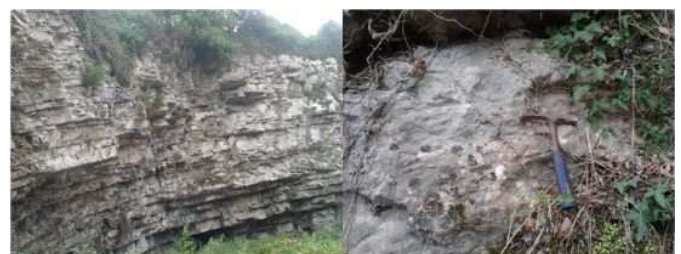
Figura 2. Aspecto de las rocas muestreadas: A la izquierda la caliza del Jurásico y a la derecha la arenisca de la Fm. Pola de Siero.
