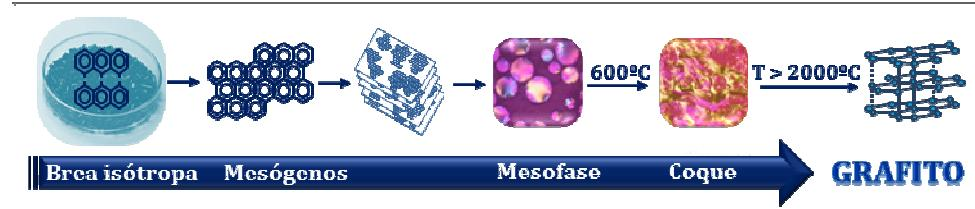
Figura 1.4. Esquema del proceso de carbonización/grafitización.
