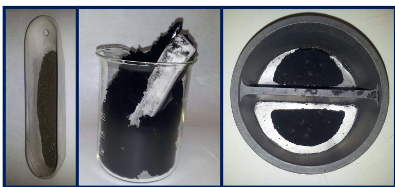
**Figura 3.13.** Imagen de a) un óxido de grafito natural preparado por el método Brodie, b) ese óxido una vez tratado a  $700 \text{ }^{\circ}\text{C}$  y c) después de llevarlo a  $2000 \text{ }^{\circ}\text{C}$ .
