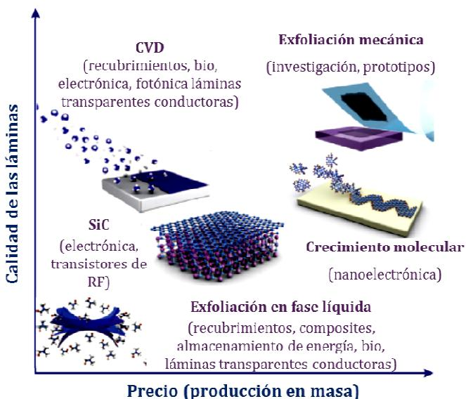
**Figura 1.12.** Precio de la producción en gran escala de grafenos frente a la calidad de las láminas. Entre paréntesis se mencionan algunas de las posibles aplicaciones de los materiales grafénicos según el método de síntesis. (Figura adaptada del artículo *A roadmap for graphene* K.S. Novoselov et al. *Nature* 2012; 490: 192-200).<sup>17</sup>
