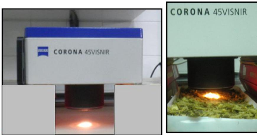
**Figura 3.5.** Presentación de la muestra al Equipo Corona 45 VisNIR 1.7 (Carl Zeiss) en posición invertida o “Down-view”.
