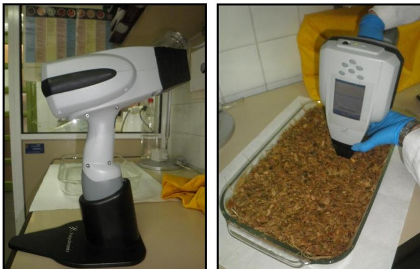
**Figura 3.6.** Equipo Phazir 1624 Handheld NIR y modo de recogida de la información espectral
