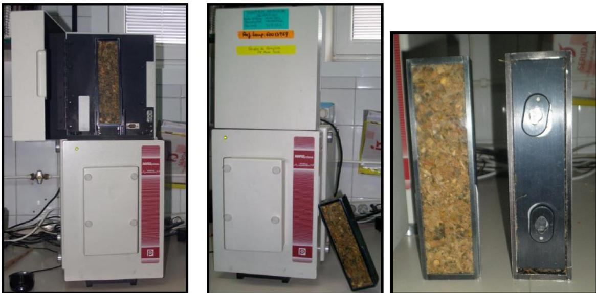
**Figura 3.2.** Equipo FOSS-NIRSystems 6500 SY-II y cápsulas para productos naturales
