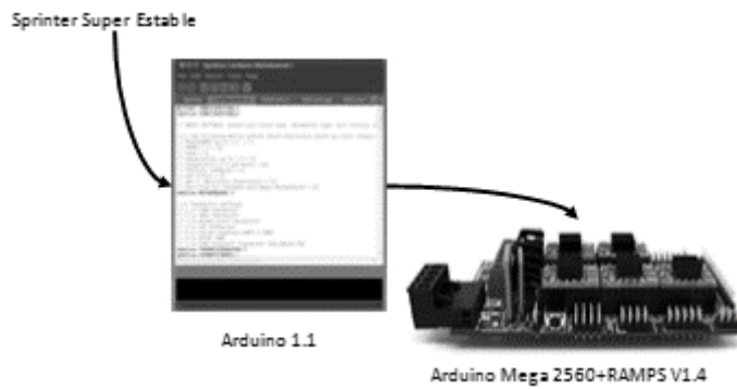
Figura 14: Diagrama ilustrativo de como programar la RAMPs v1.4
