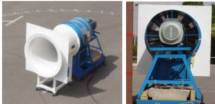
Figura 5.36. El ventilador durante los ensayos acústicos.
