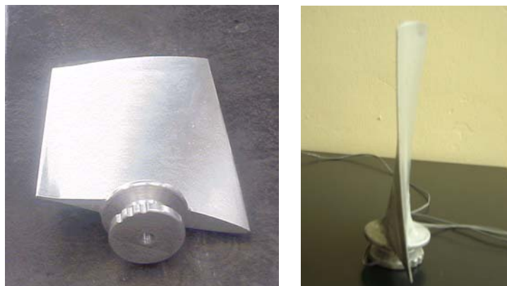
Figura 5.2. Perfiles NACA 65 de los álabes del rotor.
