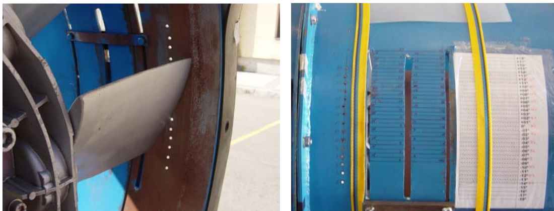
Figura 5.29. Orificios practicados en la carcasa para las medidas de presión.
