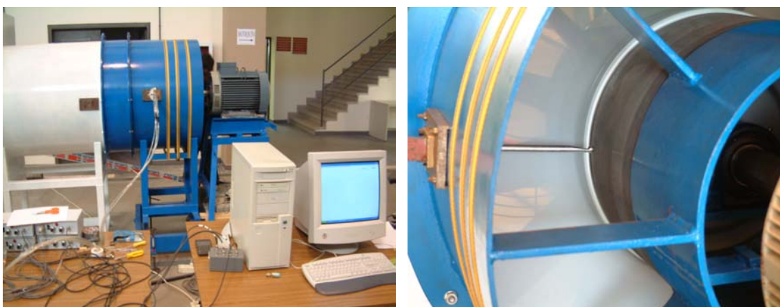
Figura 5.10. Cadena de medida y sonda adquiriendo una medida aguas abajo del rotor.
