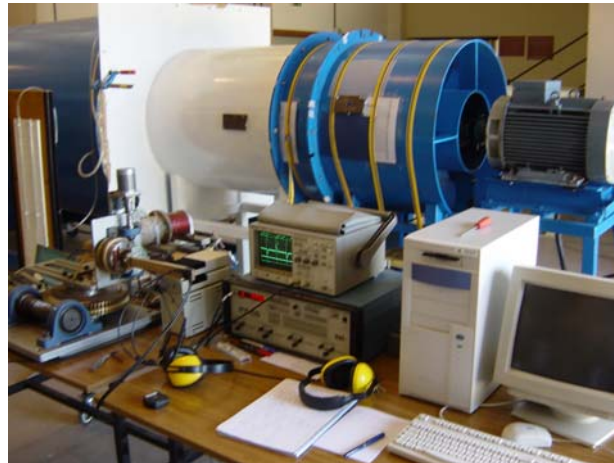
Figura 5.24. Cadena de medida completa para la anemometría térmica.
