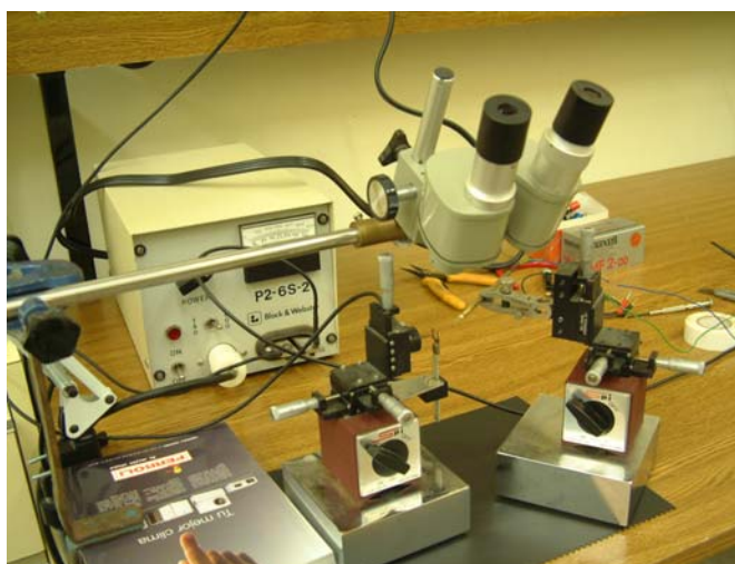
Figura 5.21. Banco de fabricación y reparación de los hilos.
